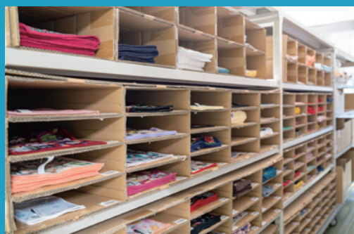
▲SKU数の多い商品の保管効率アップのため、棚の中に段ボールで小分けの棚を作り、個別にロケ管理できるように工夫されている。ピッキング効率も大幅アップ☆
