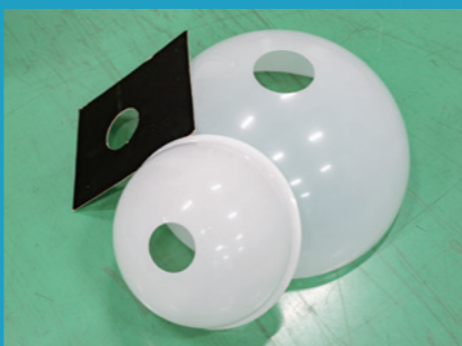
▲背景の写り込みをなくすために、白色のドームを商品にかぶせて撮影しています。ホームセンターで買ったプラ製の半球の頂点を丸く切り抜き、そこから商品を撮影します。テストとしてスプーンを撮影してもらいましたが、仕上がりの写真を比べるとクオリティの違いは一目瞭然ですね。
