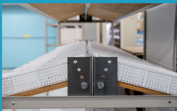
▲日本で唯一、ジュエリーの物流を受託しているオーティーエス。その本拠地である新砂センターではジュエリー/アクセサリーを取り扱うための様々な工夫が施されています。アパレルの物流と大きく違うところは商品が小さく、スペースも大きく必要としないため、座っての作業が多くなるのが特徴です。新砂センターで見つけたDIYは、座ったままの作業を効率化するための特別な棚！手前に向かって棚に傾斜をつけることで、座った状態でもものの出し入れが容易で、かつ視認性も向上しミスの低減にもひと役買っています。
