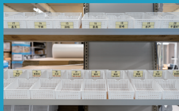
▲日本で唯一、ジュエリーの物流を受託しているオーティーエス。その本拠地である新砂センターではジュエリー/アクセサリーを取り扱うための様々な工夫が施されています。アパレルの物流と大きく違うところは商品が小さく、スペースも大きく必要としないため、座っての作業が多くなるのが特徴です。新砂センターで見つけたDIYは、座ったままの作業を効率化するための特別な棚！手前に向かって棚に傾斜をつけることで、座った状態でもものの出し入れが容易で、かつ視認性も向上しミスの低減にもひと役買っています。
